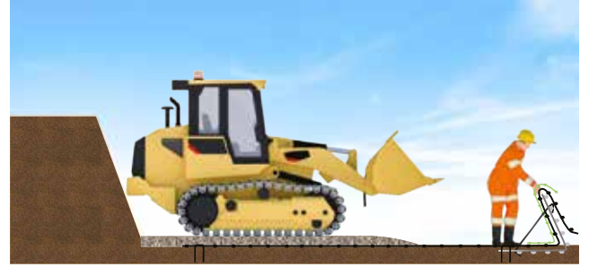
Donatılı duvar ön yüz oluşturulması
