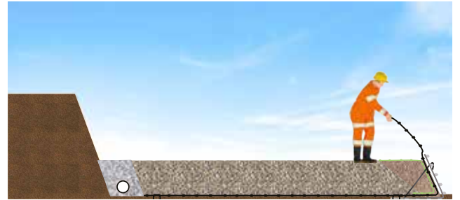
Donatılı duvar bohçanın kapatılması
