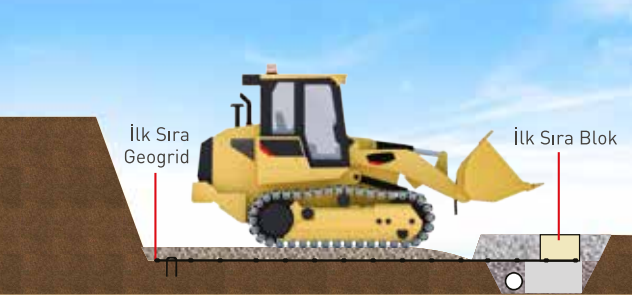
Donatılı duvar ilk sıra geogrid serilmesi
